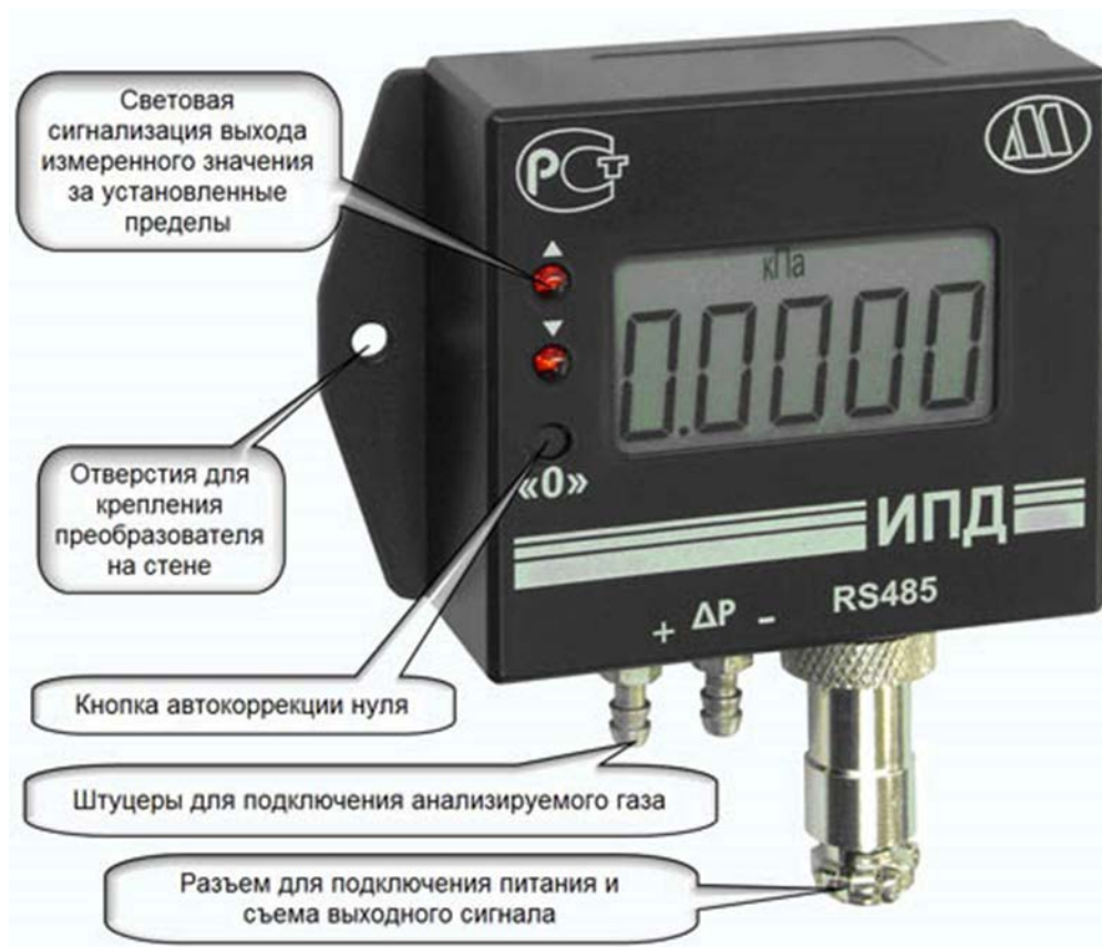
Внешний вид преобразователя разности давления ИПД-СV
