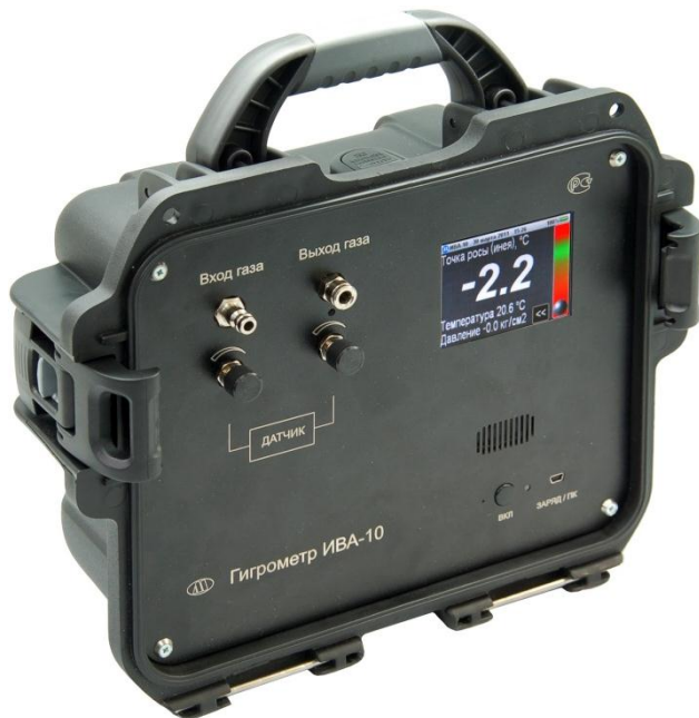
Рис.2. Лицевая панель гигрометра Ива-10 со снятой крышкой.
